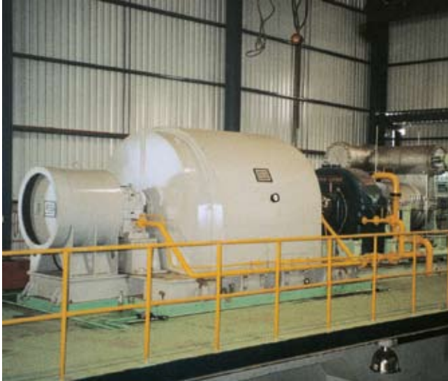
Cliente: UNI-SYSTEMS Cliente final: Engenho Monte Rosa Pais: Nicaragua Suministro: 18.750 kVA, 13.800 V, 4 polos Aplicación: Turbina a vapor (Usina de azúcar y alcohol) Combustible: Bagazo de caña Año de fabricación: 2001
